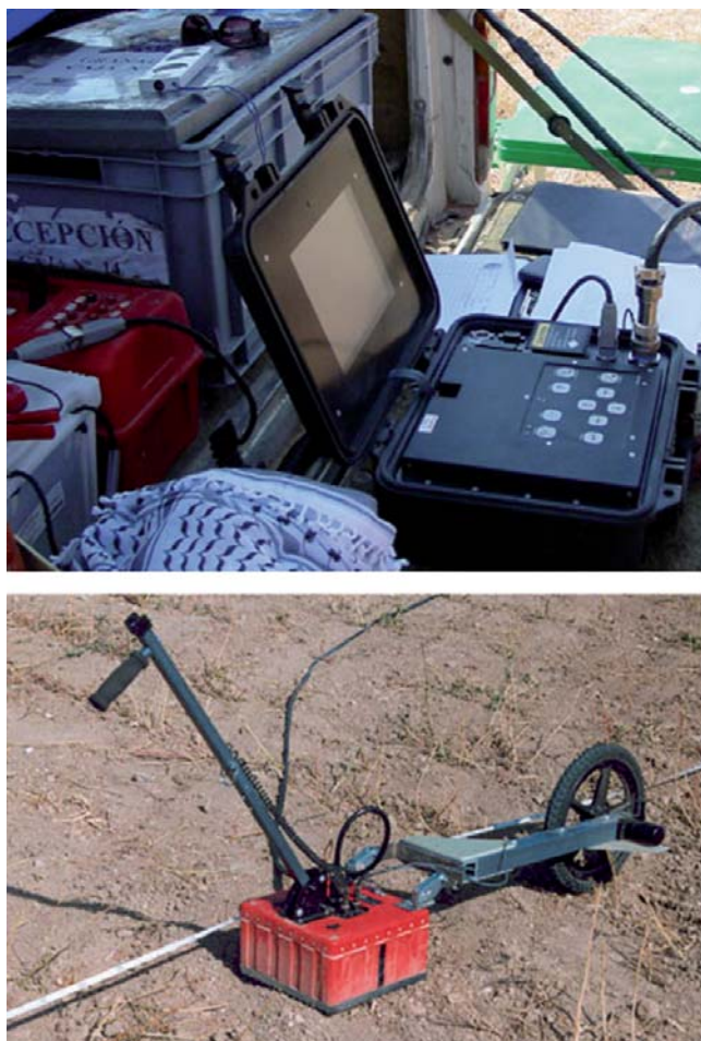
Figura 28. Consola y antena de radar de subsuelo (foto: Instituto Andaluz de Geofísica, Universidad de Granada).
