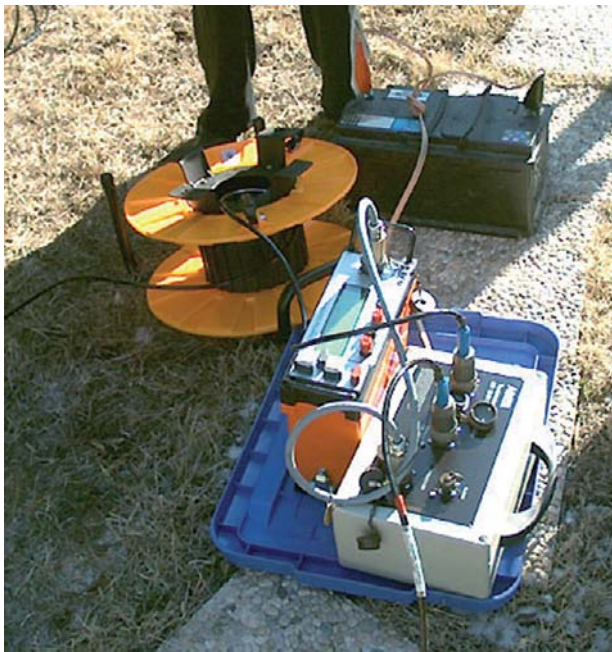
Figura 25. Resistivímetro con selector de electrodos, bobina multicable y alimentación externa mediante batería (foto: Instituto Andaluz de Geofísica. Universidad de Granada).
