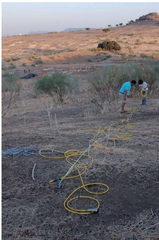
Figura 26. Trazado de un perfil de tomografía eléctrica en el yacimiento de La Bienvenida (Ciudad Real) donde se observa la extensión del cable y los electrodos clavados en el terreno para una correcta transmisión de la corriente. (Foto: G. Esteban Borrajo.)
